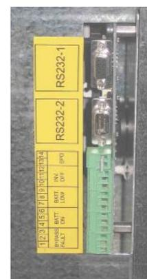
На ИБП следует удалить перемычку, имеющуюся на клеммах EPO (страница 24), а вместо нее должны быть подключены провода, идущие от контакта кнопки. Данный контакт должен быть замкнут в нормальном состоянии и размыкаться при нажатии кнопки.
